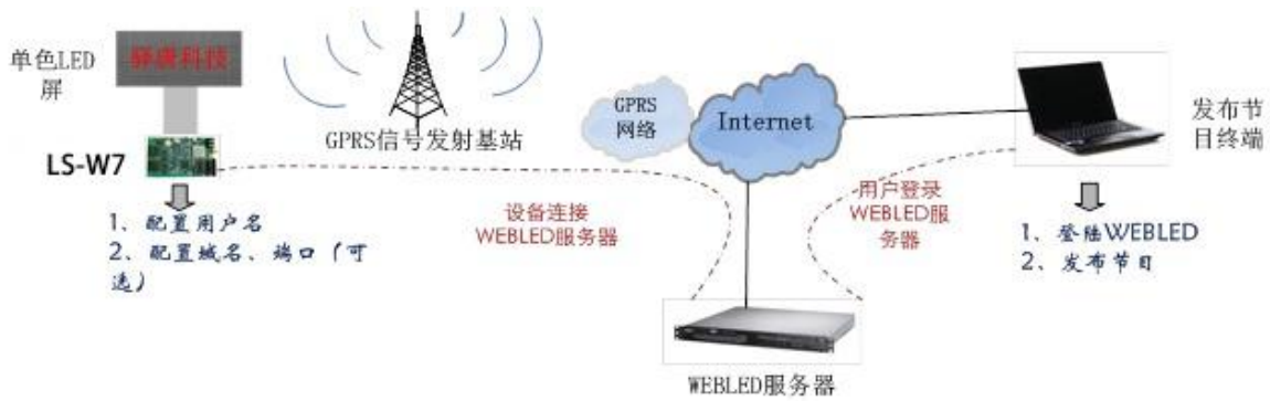
图 1-7 G16-GPRS(原 LS-W7)工作原理
